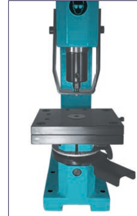
Montierter Abstreifbügel für KP 2.1 Modelle (Sonderzubehör)
