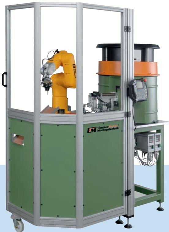
Roboterzelle mit Werkstück-Zuführung
