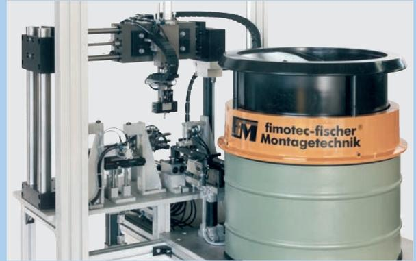
Handhabungsautomat, bestehend aus einem Bunkerzuführsystem BZS 50, Portalhandling mit Greifeinheit, sowie Vereinzelnungs- und Dreheinheit. Dünne Flachfederkontakte werden lageorientiert aus dem Bunkerzuführsystem BZS über Linearförderer in ein Vereinzelnungswerkzeug gefördert.
