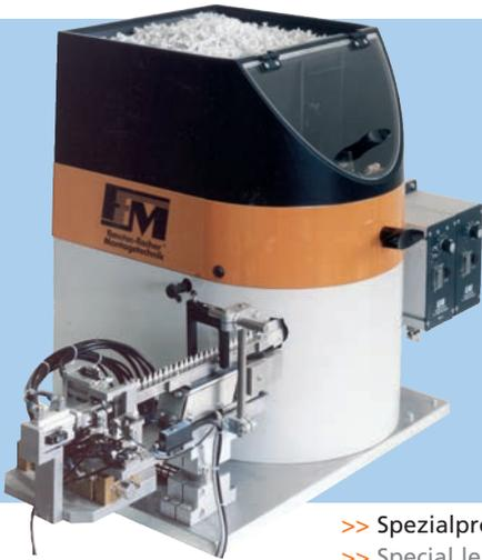
Bunkerzuführsystem BZS 30 mit Werkstückvereinzelnung. Eine patentierte Neuheit von fimotec-fischer Montagetechnik.
