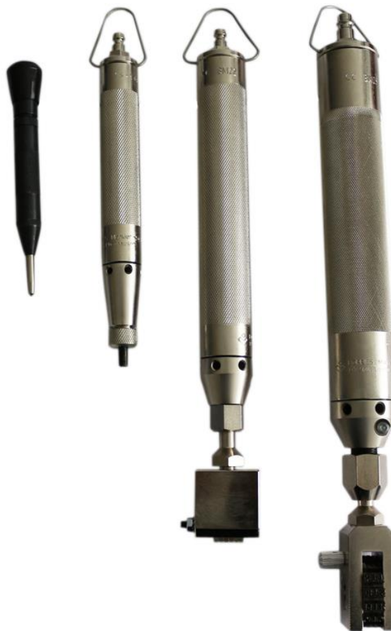
Handstempelgerät BM 10 mit als Beispiel einem Zapfenstempel
